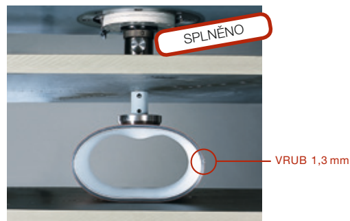
Pokus bodového zatížení bočním vrubem (ZOBRAZENÍ 3)
