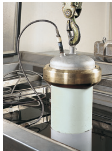
Zkouška meze časové únavy při tečení (ZOBRAZENÍ 16)
